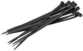
Хомуты для крепления электропроводки изготовлены из чистого 6/6 Nylon. Хомуты обладают самоконтрящимся замком. Для больших диаметров необходимо соединить два или более хомутов. Хомуты используются при температуре от -40 °С до 80 °С. Обеспечивают быстрое и надёжное соединение.
