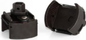
Universal-Ölfilterschlüssel für 80-115 mm Filter. Entworfen, um Ölfilter schnell und einfach zu demontieren bzw. zu installieren. Entweder mit einem 1/2" Schlüssel oder einem 21 mm Spanner verwendbar. Die Armlänge (Arbeitsbereich bzw. Tiefe) ist ca. 3 cm. Farbe: schwarz. Industriequalität empfohlen für den täglichen Einsatz in der Werkstatt und für zu Hause.
